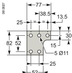
Центральная контактная пластина для 3-полюсного аппарата
