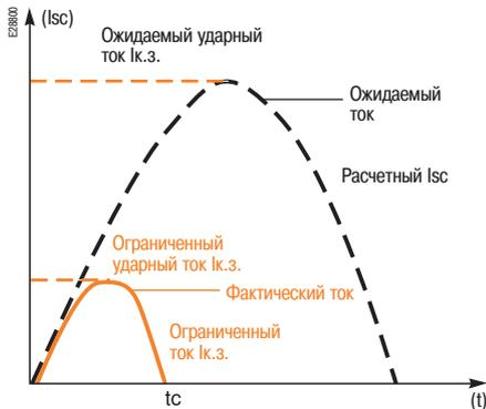
Автоматические выключатели Compact NS обеспечивают исключительное токоограничение благодаря технологии ротоактивного размыкания: быстрое естественное отталкивание контактов и введение в цепь короткого замыкания двух последовательных напряжений электрической дуги с очень крутым фронтом.
