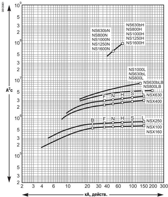
Номинальный отключаемый ток короткого замыкания (кА, действ.)
