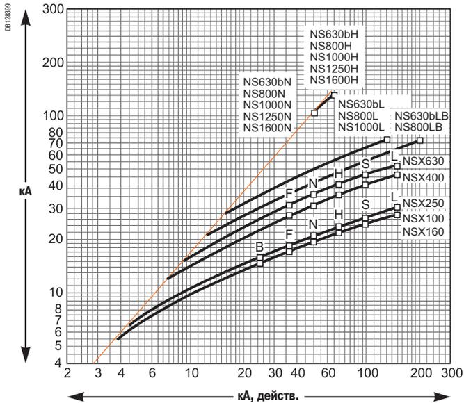
Номинальный отключаемый ток короткого замыкания (кА, действ.)
