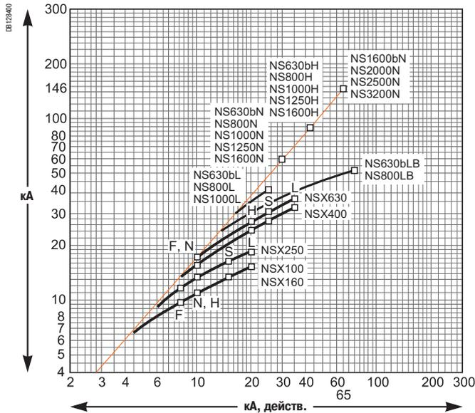
Номинальный отключаемый ток короткого замыкания (кА, действ.)
