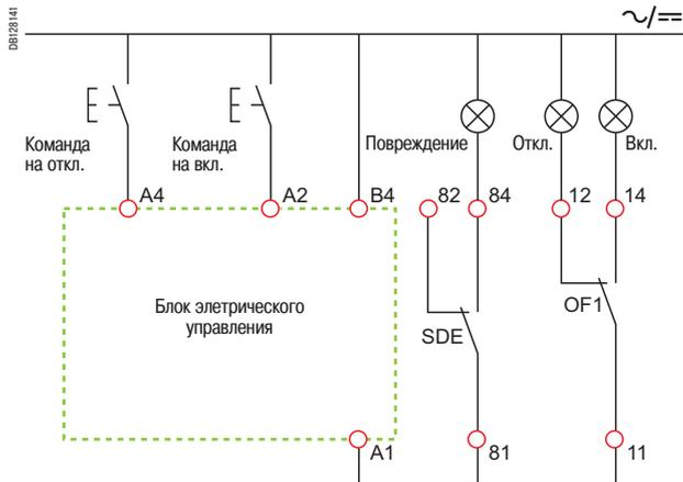
В случае одновременного поступления команд на включение и отключение моторредуктор разряжает пружину без какого-либо воздействия на главные контакты.
