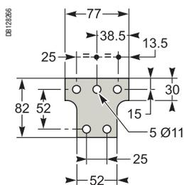
Левая или правая контактная пластина для 4-полюсного аппарата
