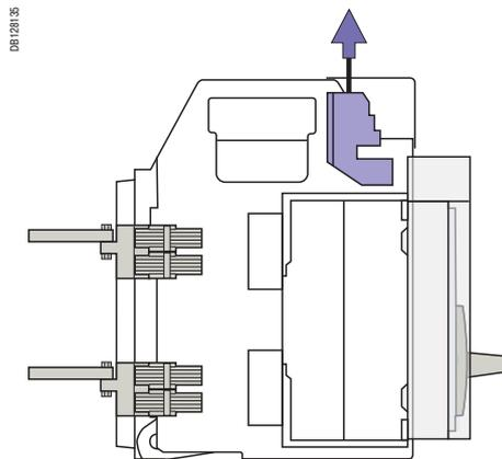
Вспомогательные контакты существуют также в слаботочном исполнении. Это исполнение применяется для коммутации очень малых нагрузок: например, цепи программируемых контроллеров и прочие электронные цепи.
