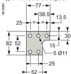
Центральная контактная пластина для 3-полюсного аппарата
