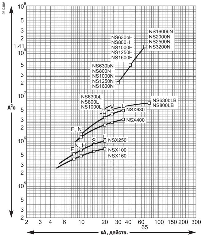
Номинальный отключаемый ток короткого замыкания (кА, действ.)
