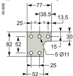
Центральная контактная пластина для 3-полюсного аппарата
